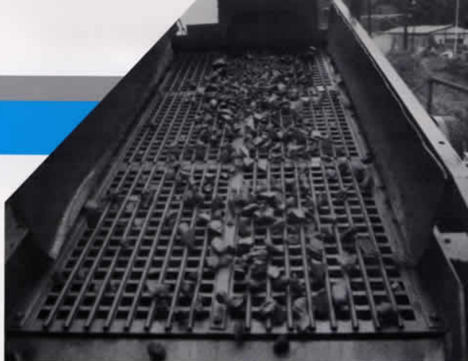
骨材篩分け用打抜鋼板 (摩耗防止のため、特殊ロッド補強)
