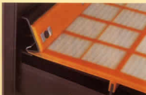
細粒のふるい分けや脱水用として、長穴の幅が0.25~2.5mm迄で長穴の長さは各種のものが製作可能です。 (セグメント網目)
